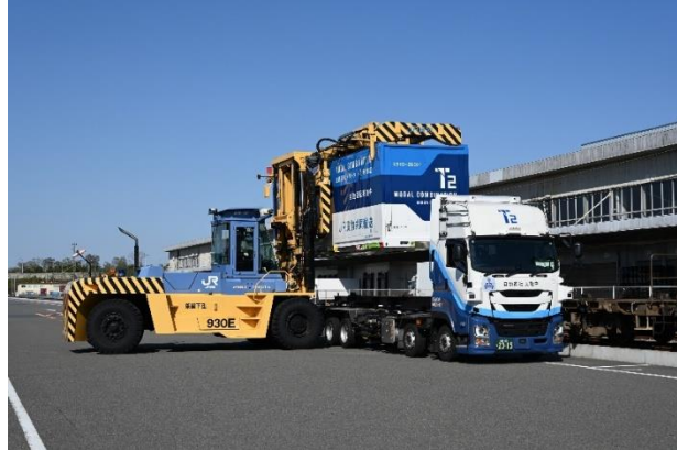
T2 のトラックから共用コンテナを積み替える様子
