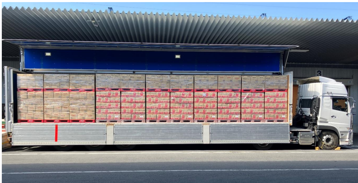
下段に伊藤園の飲料(重量物)、上段に森永製菓の菓子(軽量物)を混載
