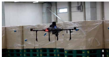
パレットを貨物に見立てたテストコースで、床面と貨物との位置関係をレーザーで検知して、半自律飛行するドローン
