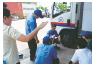
点検ハンマーによるタイヤ、ホイール等の点検
