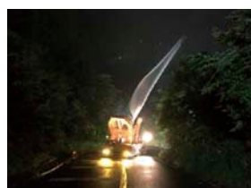
起立装置による羽根運搬（左：羽根を寝かせた場合、右：羽根を立てた場合）
