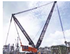
1350t吊能力クローラクレーン
