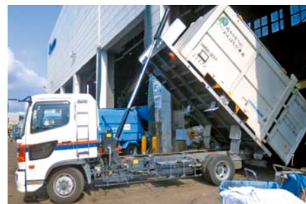
都内中間処理施設でのダンパアップによる取卸し
