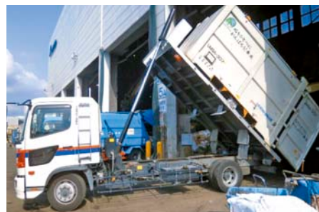
都内中間処理施設でのダンプアップによる取卸し
