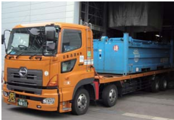
オープントップコンテナ輸送容器を使用した汚泥輸送
