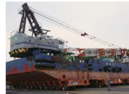
陸地に打ち上げられていた起重機船の撤去
