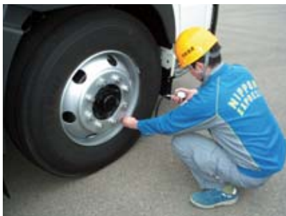
タイヤゲージによる空気圧チェック
