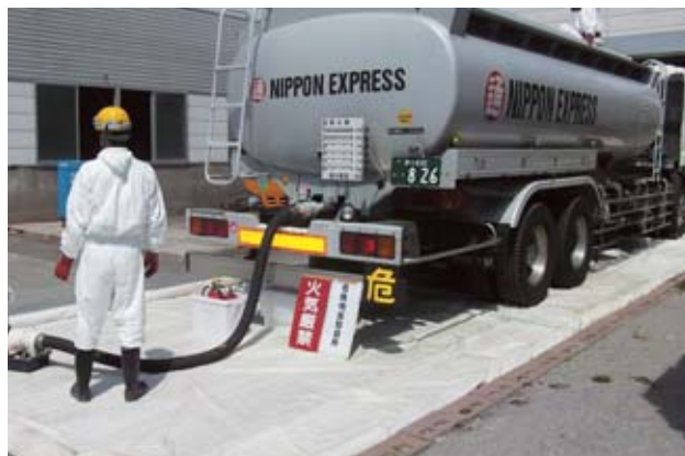
PCB運搬車両(タンクローリー)
