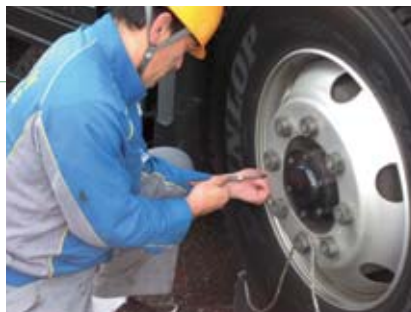
タイヤゲージ（ペン式）による空気圧チェック
