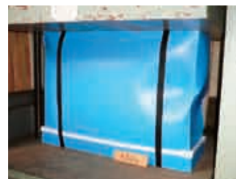
圧縮試験 破壊状況 (負荷荷重 580kg)
