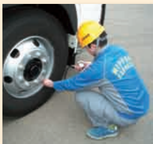
タイヤゲージによる 空気圧チェック
