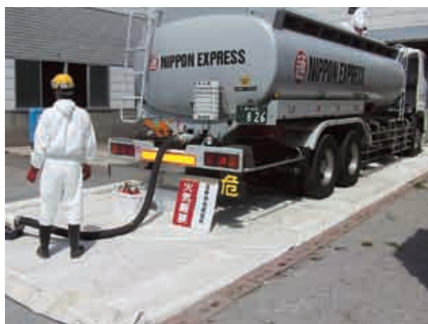
PCB運搬車両(タンクローリー)
