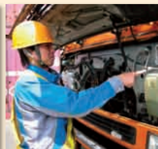
サイトグラスによる エアコンガスの状態チェック
