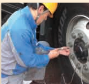
タイヤゲージ（ペン式）による 空気圧チェック
