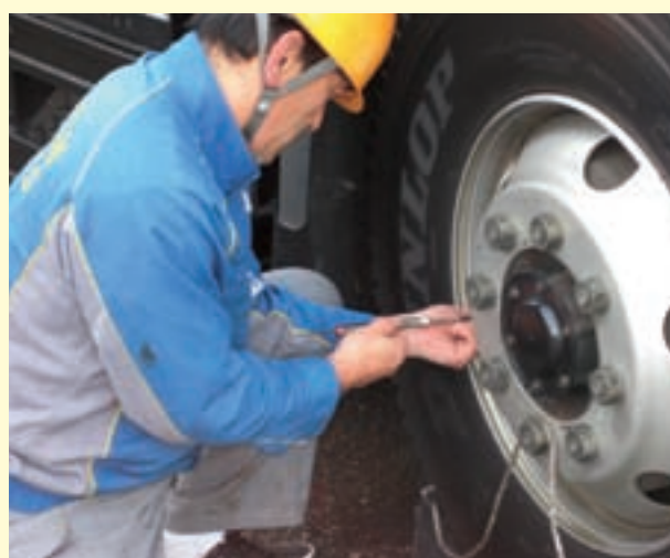
タイヤゲージ(ペン式)による空気圧チェック
