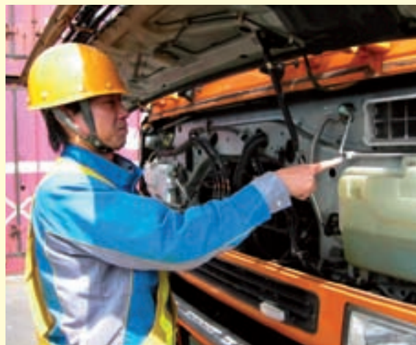
サイトグラスによるエアコンガスの状態チェック
