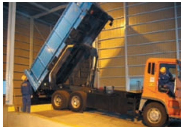
オープントップコンテナによる汚泥取卸し
