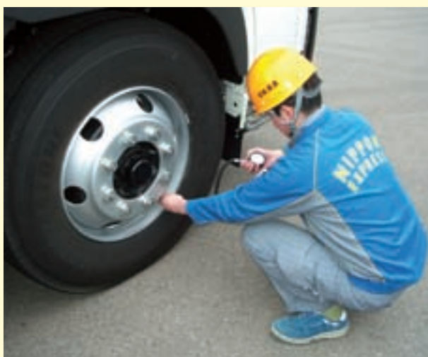
タイヤゲージによる空気圧チャック
