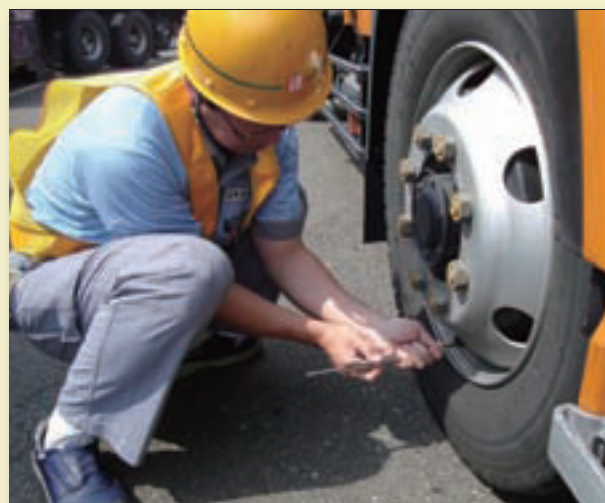
空気圧の測定(ペン式ゲージ)
