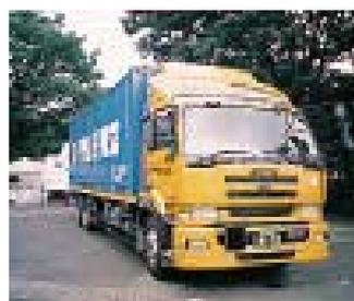
CNG 大型トラック (JR5トンコンテナ2個積み仕様)
