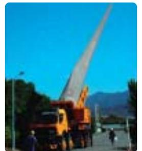
ブレード起立走行装置を使用した風車用ブレードの輸送
