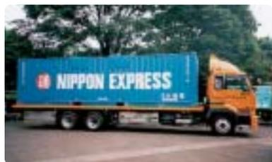
国内で初めて導入したCNG（天然ガス）大型トラック
