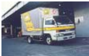
メタノール車 アルコールの一種であるメタノール（メチルアルコール）を燃料とするエンジンを用いた自動車。
