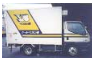
LPガス車 液化石油ガスを燃料とするエンジンを用いた自動車。
