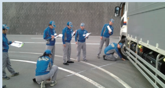
技术道场的情景。为了防止卷入、碰撞事故，确认内轮差。
